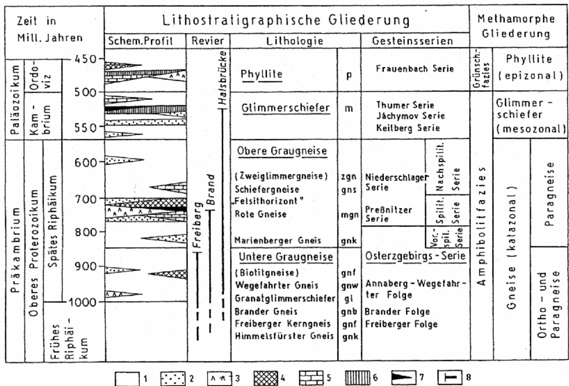
Abb.6.2 Geologisches Profil durch den Freiburger Lagerstädtendistrikt (mit den wichtigsten Nebengesteinen der Grubenreviere) (nach BAUMANN 1994c).
